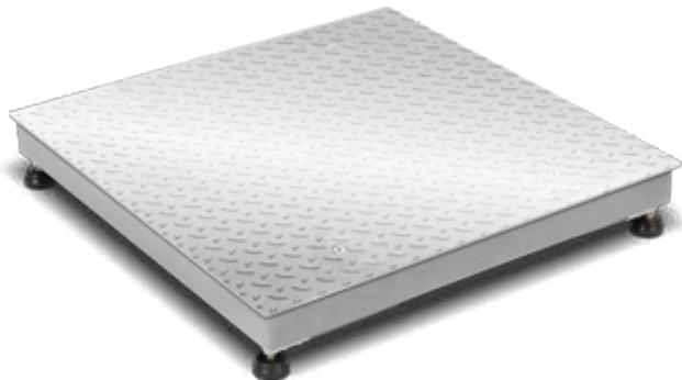
Plateforme 4 capteurs monobloc en acier inox, avec capteurs flexions en acier inox, de faible hauteur elle est conçue pour le pesage dans les applications industrielles et commerciales les plus diverses. Disponible en métrologie légale CE-M pour le pesage réglementé.
